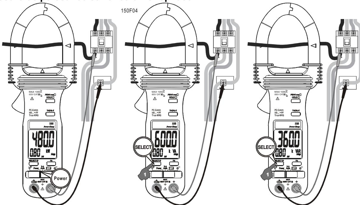
**Mesure de puissance sur circuit triphasé à 4 fils (3~ 4W) :**
