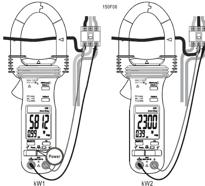
Sowohl bei balancierten wie auch bei unbalancierten Lasten im 3-Phasen - 3 Drahtsystem ( $3\sim 3W$ ) werden die Komponenten  $kW_1$  und  $kW_2$  wie illustriert separat gemessen. Die totale Leistung  $kW_{\text{Total}}$  ist demnach die Summe der beiden gemessenen Lasten, d.h.:
