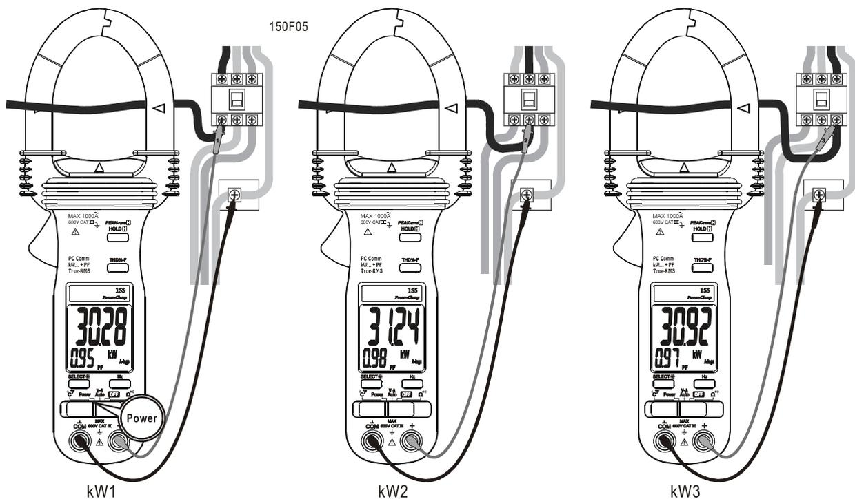
Sowohl bei balancierten wie auch in unbalancierten Lasten werden die einzelnen Phasen wie oben dargestellt gegenüber dem Nullleiter kW<sub>1</sub>, kW<sub>1</sub> und kW<sub>3</sub> gemessen. Die totale Leistung ist die Summe der drei Phasen-zu-Nullleiter Messungen, das heisst::
