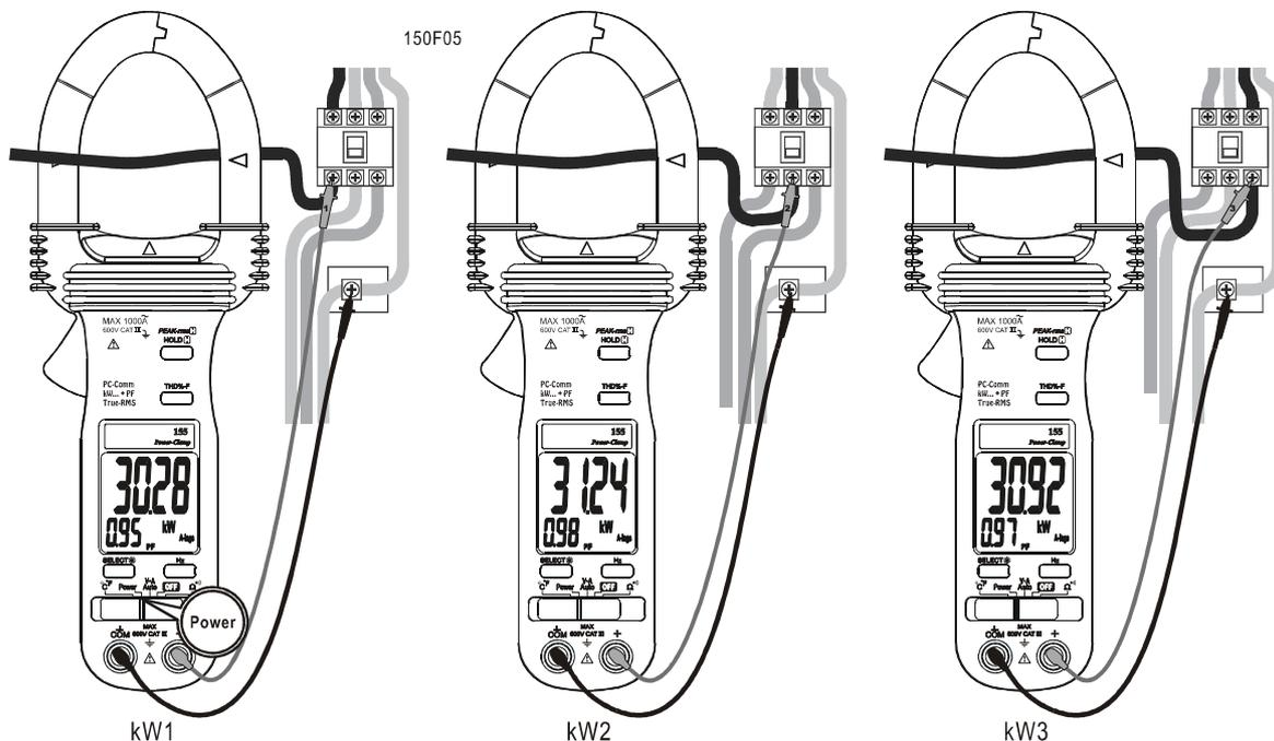
En cas de charges équilibrées ou déséquilibrées, les différentes phases seront mesurées comme indiqué ci-dessus entre kW<sub>1</sub>, kW<sub>2</sub> et kW<sub>3</sub> et le conducteur de neutre. La puissance totale est la somme des trois mesures entre phase et neutre :
