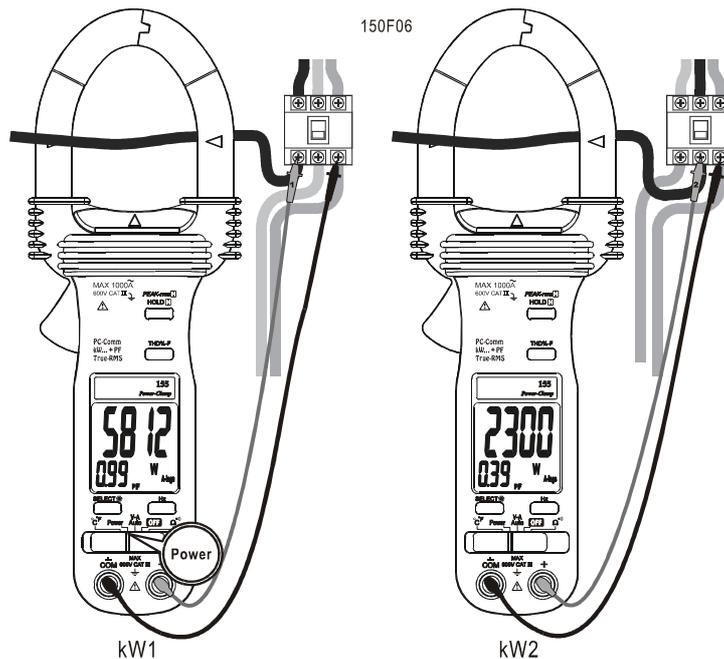
En cas de charges équilibrées ou déséquilibrées dans des circuits triphasés à 3 fils ( $3\sim 3W$ ), les composantes  $kW_1$  et  $kW_2$  seront mesurées séparément comme indiqué ci-dessus. La puissance totale  $kW_{\text{Total}}$  devient par conséquent la somme des deux charges mesurées, c. à d. :
