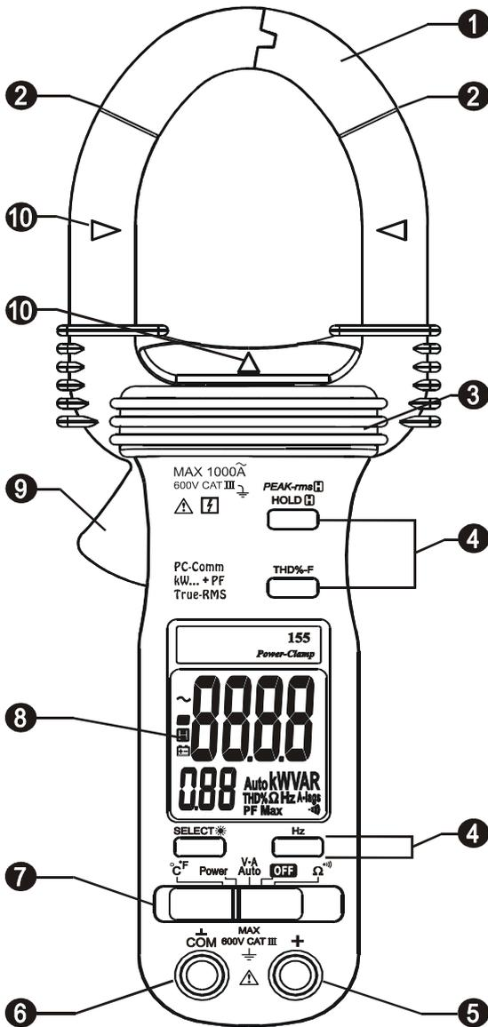
1. Pince ampèremètre à induction mesurant le courant proportionnellement au champ électromagnétique.
